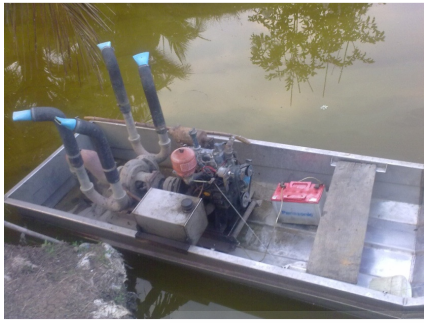
รูปที่ 6 เรือร่อนน้ำใช้เครื่องยนต์ดีเซลขนาด 18 แรงม้า
