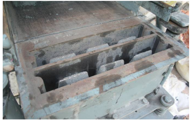
รูปที่ 2 แบบหล่อคอนกรีตบล็อกกลางขนาด 7x19x39 ลบ.ซม.
