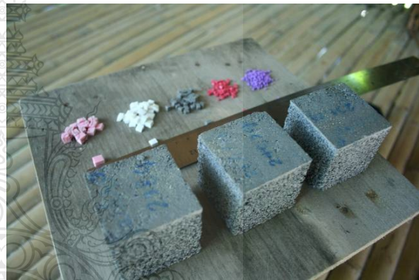
รูปที่ 3 คอนกรีตผสมเศษพลาสติกอีวีเอขนาด 5x5x5 ลบ.ซม.
