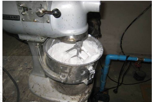
รูปที่ 1 การผสมผงยิปซัมเข้ากับน้ำประปาด้วยเครื่องผสมแบบอัตโนมัติ
