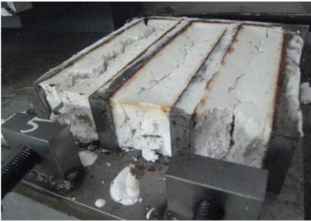
รูปที่ 2 การทดสอบความแข็งแรงของมอร์ตาร์ยิปซัมที่มีอัตราส่วนเนื้อเยื่อต่อผงยิปซัม (P/G) เท่ากับ 0.100
