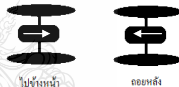
ภาพที่ 2 การควบคุมทิศทางการเคลื่อนที่ของมอเตอร์และล้อ
