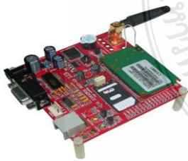
ภาพที่ 4 ชุดโมดูลจีพีอาร์เอส (General Packet Radio Service:GPRS)
