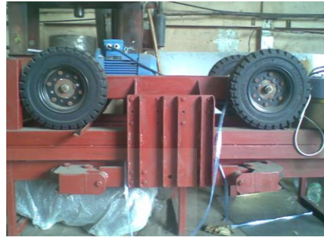
ภาพที่ 9 โครงสร้างรถไฟฟ้ารางเดี่ยว
