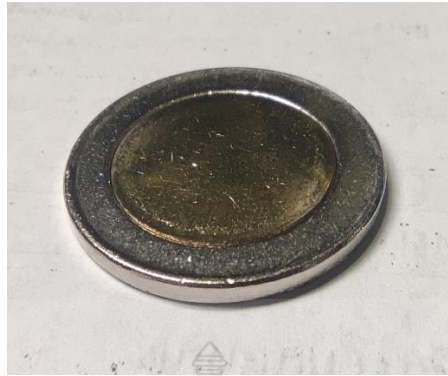
รูปที่ 3.11 เหรียญตัวเปล่าถูกยกขอบเหรียญขึ้น (Coin Rimming)
