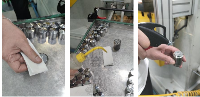
รูปที่ 3.2 ขั้นตอนการทำความสะอาดดวงตรา
