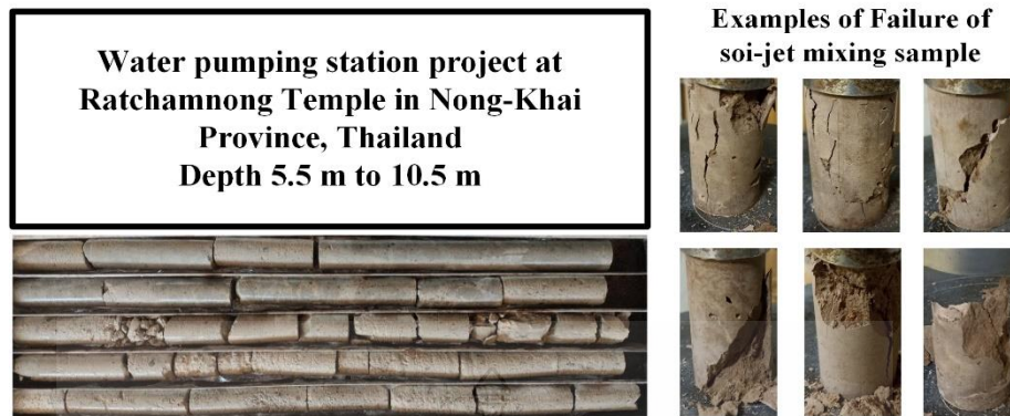
รูปที่ 4.10 ตัวอย่างดินซีเมนต์ที่ได้จากการเจาะแกนเสาเข็มดินซีเมนต์ในภาคสนามที่ระดับความลึก 0-10 เมตร
