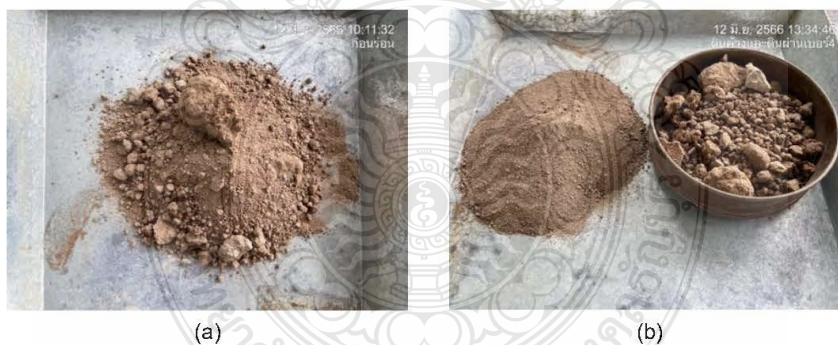
รูปที่ 1 ลักษณะของดินตัวอย่างก่อนร่อน (a) และลักษณะของดินตัวอย่างหลังร่อนผ่านตะแกรงเบอร์ 4 (b)
