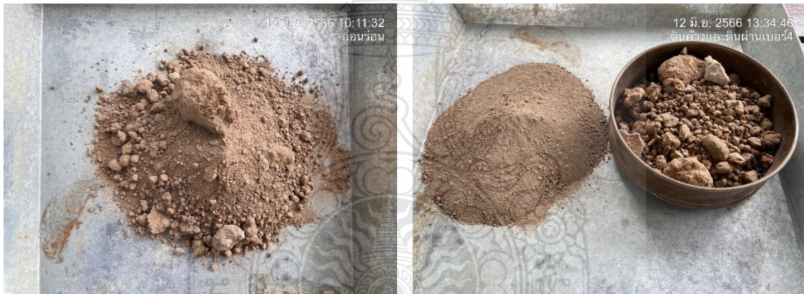
รูปที่ 3.1 แสดงลักษณะของดินตัวอย่างก่อนร่อน (a) และลักษณะของดินตัวอย่างหลังร่อนผ่านตะแกรงเบอร์ 4 (b)
