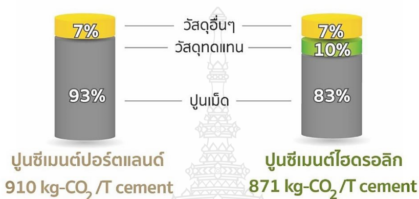
รูปที่ 2.15 เปรียบเทียบการลดการปล่อยก๊าซคาร์บอนไดออกไซด์ กรณีใช้วัสดุทดแทนที่ร้อยละ 10 (สมาคมอุตสาหกรรมปูนซีเมนต์ไทย [74])
