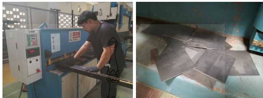
รูปที่ 3.6 การตัดชิ้นงานด้วยเครื่องตัดเหล็กแผ่น (ซ้าย) และชิ้นงานเมื่อตัดเสร็จ (ขวา)
