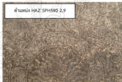
รูปที่ 4.49 โครงสร้างจุลภาคของรอยต่อเกยตำแหน่งระยะห่างจากชิ้นงานรอยต่อเกย 2.0 มิลลิเมตร เหล็กกล้า SPH590 กระแสไฟเชื่อม 260 แอมแปร์
