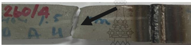
รูปที่ 4.21 ตำแหน่งการพังทลายของชิ้นงานทดสอบความแข็งแรงดึงของรอยต่อเกล็กกล้า SPH590 แนวนอน ตำแหน่งหัวเชื่อมขยับออกจากรอยต่อแนวเชื่อม 1.5 มิลลิเมตร
