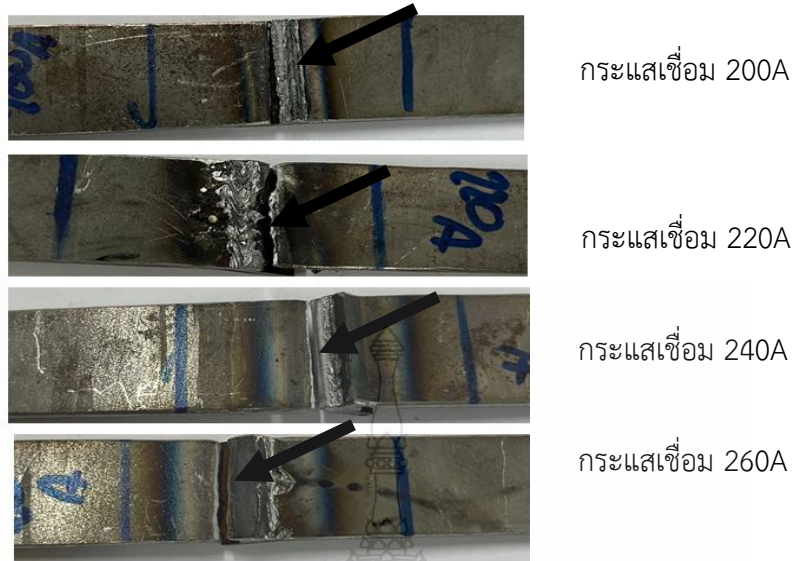
รูปที่ 4.41 ตำแหน่งการพังทลายของชิ้นงานทดสอบความแข็งแรงดึงของรอยต่อเกลียวเหล็กกล้า SPH590 ตำแหน่งชิ้นงานขยับออกจากรอยต่อแนวเชื่อม 2.0 มิลลิเมตร
