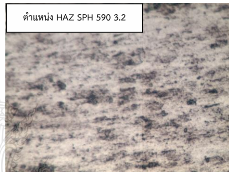
รูปที่ 4.5 โครงสร้างพื้นฐานของโลหะฐาน SPH 590 ขนาด 2.9 กับ 3.2 มิลลิเมตร
