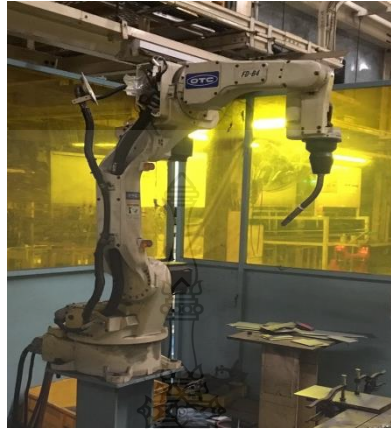
รูปที่ 3.4 แสดงหุ่นยนต์เชื่อม OTC Daihen FD-B4L
