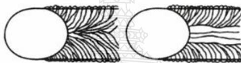
แบบรูปไข่ ความเร็วในการเชื่อมต่ำ
