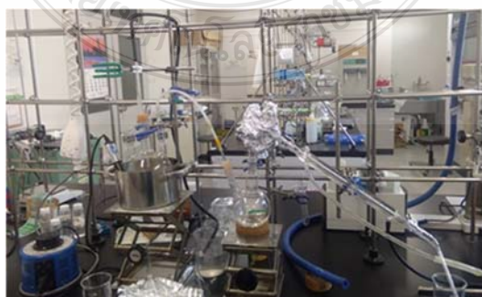
รูปที่ 3.5 ชุดทดสอบปริมาณไนโตรเจนด้วยวิธี Kjeldahl's method
