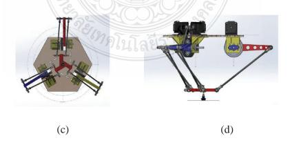
Figure 3.3 Parallel Robot structure (c) Bottom View (d) Side View
