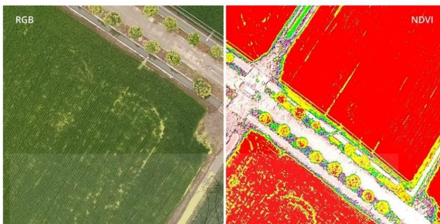
ภาพที่ 2.20 ภาพถ่ายเชิงพื้นที่ด้วยกล้องมัลติสเปกตรัมและตัวอย่างการประมวลผลภาพชนิด NDVI [38]
