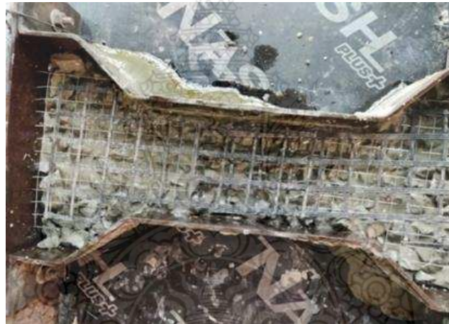
รูปที่ 3.21 ตัวอย่างคอนกรีตรูป Dog Bone เสริมจีโอกริดแบบทาบรอยต่อ 2 ช่อง
