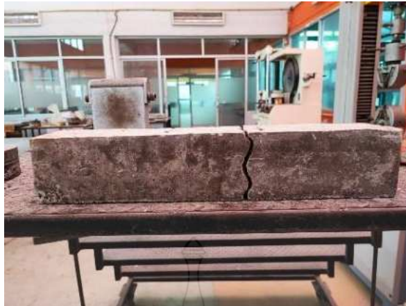
รูปภาพ ก 9 การวิบัติของตัวอย่างคอนกรีตคานแบบไม่เสริมแรง ที่เกิดจากแรงดัด
