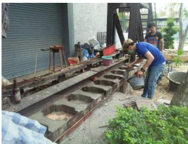
รูปที่ 3.23 ทำการปาดผิวหน้าคอนกรีตรูป Dog Bone ทั้งแบบเสริมจีดกริด และแบบไม่เสริมจีโอกริต
