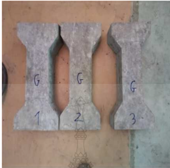
รูปภาพ ก 5 การวิบัติของตัวอย่างคอนกรีตรูปตัวไอแบบเสริมจีโอกริด ที่เกิดจากแรงดึงโดยตรง
