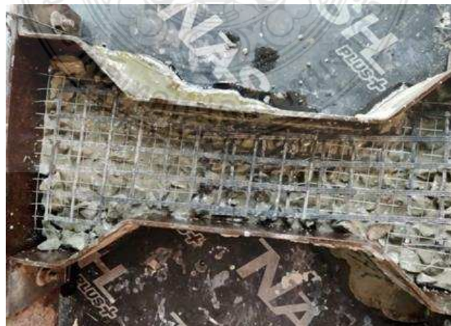
รูปที่ 3.22 ตัวอย่างคอนกรีตรูป Dog Bone เสริมจีโอกริดแบบทาบรอยต่อ 3 ช่อง
