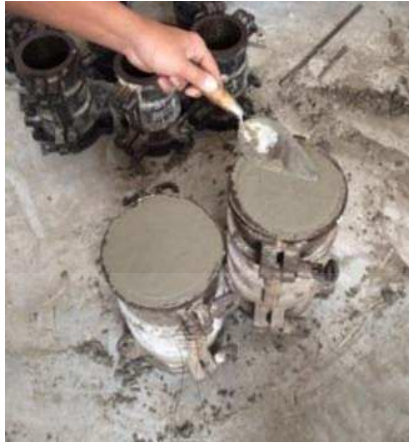
รูปที่ 3.18 ทำการปาดผิวหน้าคอนกรีตทรงกระบอก
