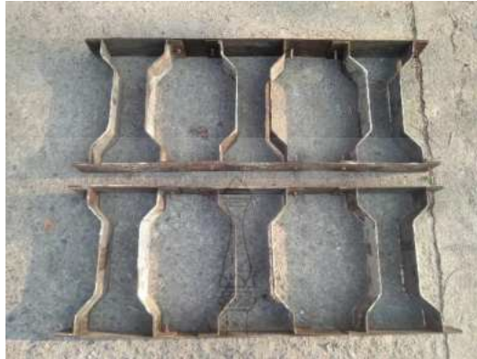
รูปที่ 3.7 แบบหล่อตัวอย่างของคอนกรีตรูป Dog Bone
