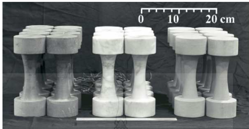
รูปที่ 2.5 ตัวอย่างรูป Dog Bone ที่ใช้ทดสอบแรงดึงโดยตรง [2]
