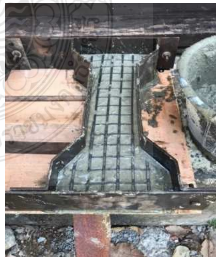
รูปที่ 3.19 ขนาดของตัวอย่างคอนกรีตรูป Dog Bone และการเสริมจีโอกรีต
