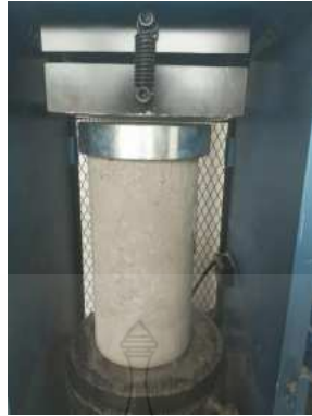
รูปที่ 3.28 ทำการทดสอบกำลังอัดตัวอย่างคอนกรีตทรงกระบอก
