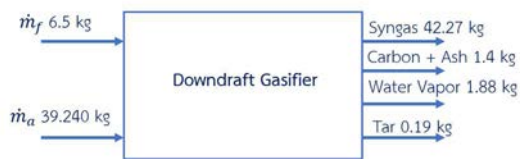
รูปที่ 3.30 ไดอะแกรมสมดุลมวลของระบบแก๊สซิไฟเออร์เมื่อระบบเป็น With PMHR
