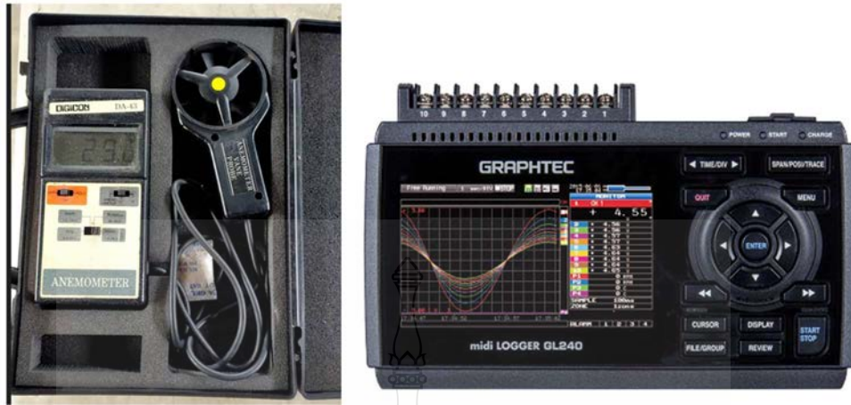
รูปที่ 3. 25 เครื่องมือวัดความเร็วของอากาศ (Air Anemometer) และเครื่องบันทึกอุณหภูมิ (Temperature Data Logger)
