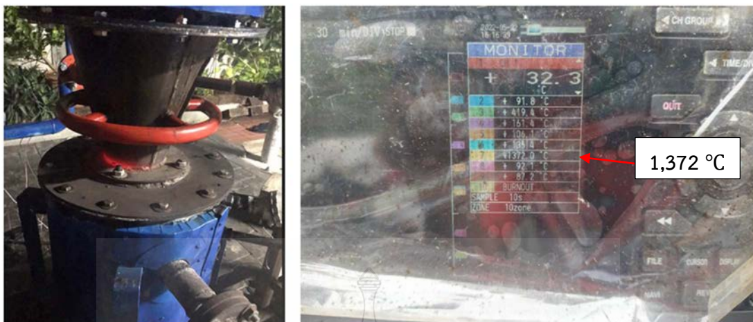
รูปที่ 3.16 อุณหภูมิสูงสุด 1,372 °C ที่วัดได้ที่ตำแหน่งของโซนเผาไหม้ขณะทำการทดสอบ
