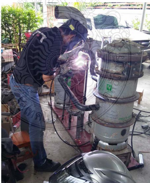
รูปที่ 3.11 การติดตั้งอุปกรณ์แลกเปลี่ยนความร้อนและส่วนต่างๆของเตาแบบไหลลง
