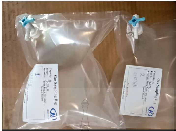
รูปที่ 3.28 ถุงเก็บตัวอย่างแก๊สสังเคราะห์เพื่อนำไปวิเคราะห์ยังห้องทดสอบ
