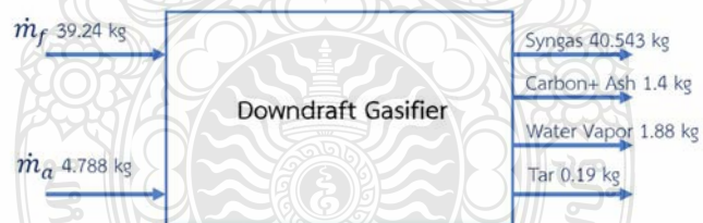
รูปที่ 3.42 ไดอะแกรมสมดุลมวลระบบแก๊สซิไฟเออร์เมื่อระบบ Without PMHR
