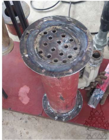
รูปที่ 3.20 อุปกรณ์แลกเปลี่ยนความร้อน (Heat Eexchangers) เมื่อประกอบเสร็จเรียบร้อยแล้ว
