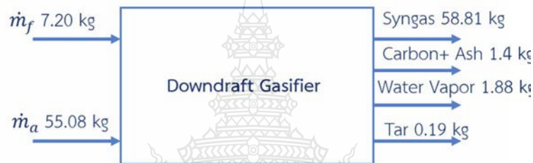
รูปที่ 3.40 ไดอะแกรมสมดุลมวลระบบแก๊สซิไฟเออร์เมื่อระบบ With Empty PMHR
