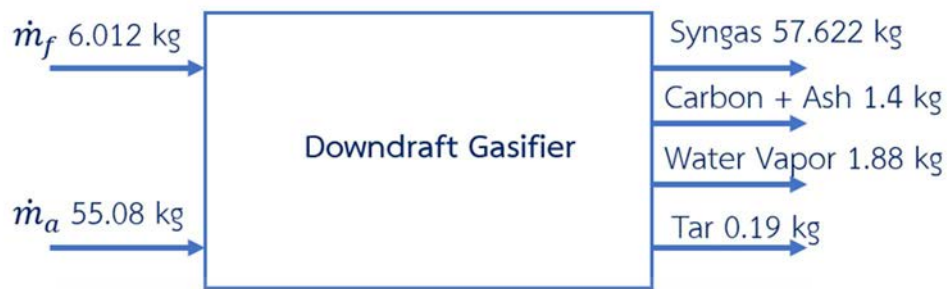
รูปที่ 3.44 ไตอะแกรมสมดุลมวลระบบแก๊สซิไฟเออร์เมื่อระบบ Without PMHR
