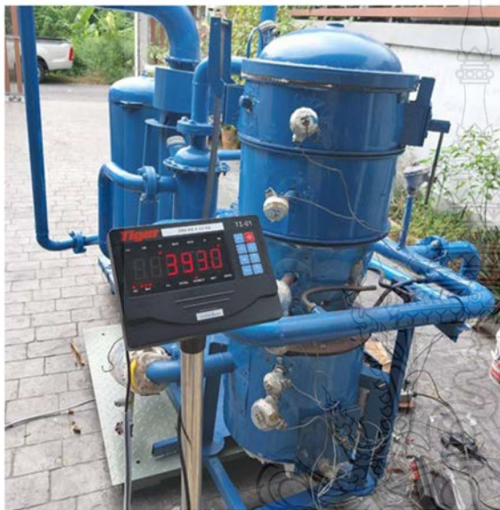
รูปที่ 3.27 เครื่องชั่งน้ำหนักแบบดิจิตอล (Load Cell) และ เครื่องชั่งน้ำหนักแบบสปริง
