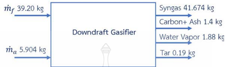
รูปที่ 3.36 ไตอะแกรมสมดุลมวลระบบแก๊สซิไฟเออร์เมื่อระบบ With Empty PMHR
