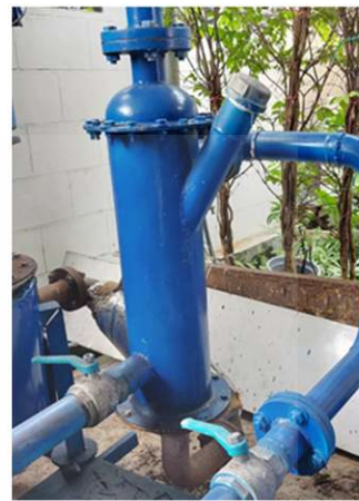
รูปที่ 3.20 อุปกรณ์แลกเปลี่ยนความร้อน (Heat Eexchangers) เมื่อประกอบเสร็จเรียบร้อยแล้ว
