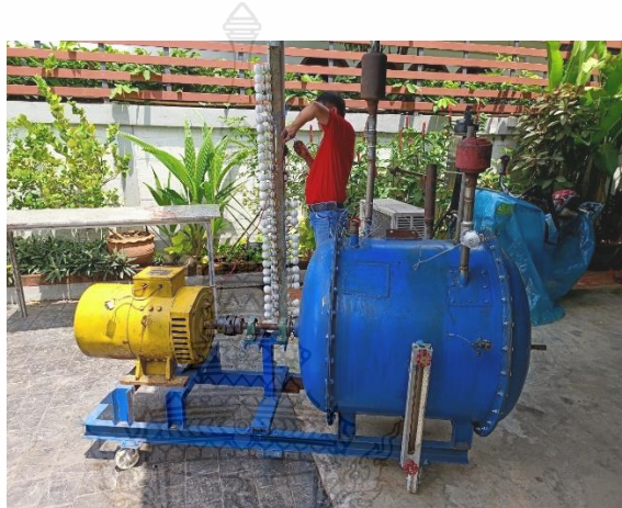
รูปที่ 3.11 ต่อสายไฟ output เข้ากับสวิตช์โหลดหลอดไฟ
