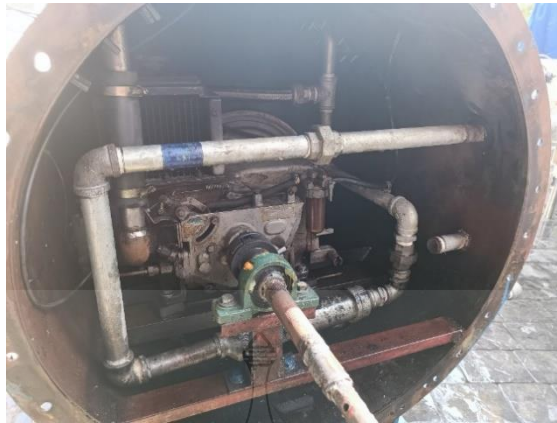
รูปที่ 3.9 เครื่องยนต์ถูกติดตั้งลงภายในถัง
