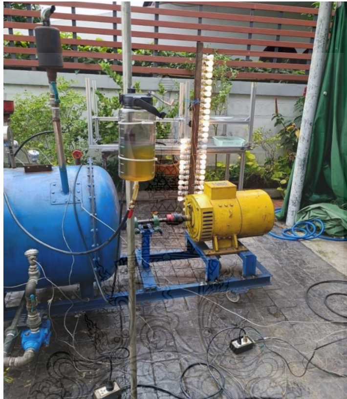
รูปที่ 3.19 การทดสอบที่ 2 แบบปิดฝาถัง-ไอเสียออกภายนอก
