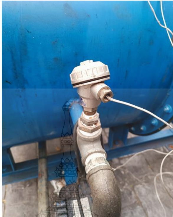
รูปที่ 3.15 ติดตั้งเทอร์โมคัปเปิ้ลไว้ที่โอเสีย
