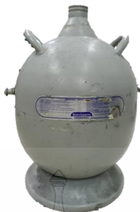
รูปที่ 3.6 ถังไนโตรเจนเหลว ขนาด 25 ลิตร
