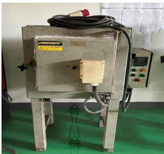
รูปที่ 3.3 เตาอบอ่อนชิ้นงานทองแดงบริสุทธิ์ที่ยี่ห้อ Nerberthem รุ่น N 60A
