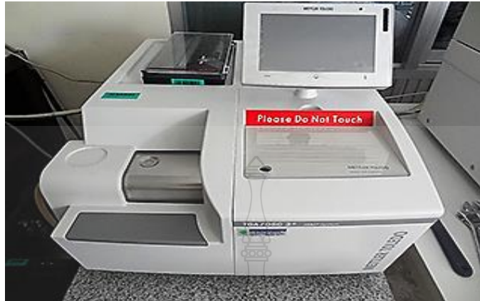
รูปที่ 2.23 เครื่องวิเคราะห์การเปลี่ยนแปลงน้ำหนักของสารโดยอาศัยคุณสมบัติทางความร้อน
