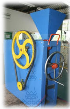
รูปที่ 2.35 การออกแบบและพัฒนาเครื่องแกะเม็ดบัวหลวง [7]
