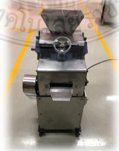
รูปที่ 4.2 เครื่องแกะเปลือกเมล็ดบัวหลวง ที่ออกแบบและสร้างเสร็จ
