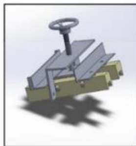
รูปที่ 7 ชุดใบมีดเครื่องแกะเมสส์บัวหลวง
