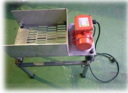
รูปที่ 4.3 ชุดคัตแยกเปลือกเมล็ดบัวหลวงที่ออกแบบและสร้างเสร็จ
