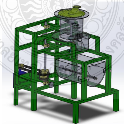
รูปที่ 3.1 เครื่องย่อยและผสมสำหรับวัสดุปลูกจากเปลือกทุเรียน 1)โครงสร้างเครื่อง 2)ชุดย่อย 3)ชุดผสม 4)ระบบส่งกำลัง
