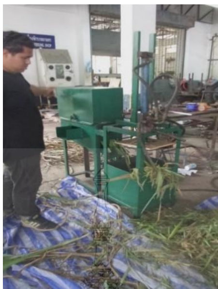
รูปที่ 2.11 เครื่องย่อยย่อยและอัดหญ้าอาหารสัตว์สำหรับเกษตรกรรายย่อย [12]
