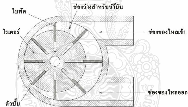
รูปที่ 2.1 ส่วนประกอบของปัมแบบใบพัด (Vane Pump) [5]
