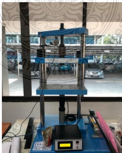
รูปที่ 3.11 เครื่องทดสอบแรงดึง TM 115A UNIVERSAL TESTING MACHINE, 50 kN.
