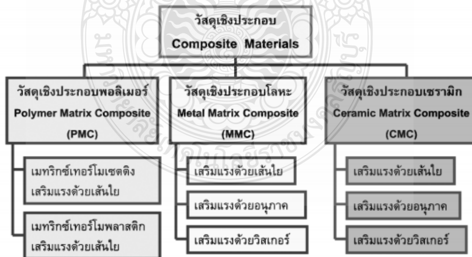
รูปที่ 2.29 การจำแนกประเภทของวัสดุเชิงประกอบตามชนิดของเมทริกซ์และลักษณะของสารเสริมแรง [11]
