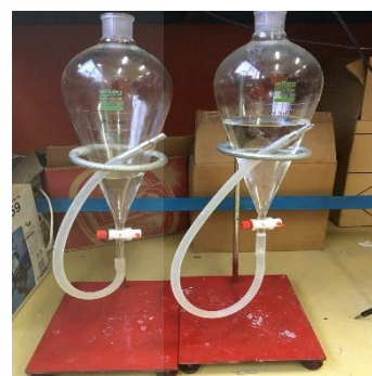
รูปที่ 3.7 สารละลายโซเดียมคลอไรด์ (NaCl) สารละลายโซเดียมไฮดรอกไซด์ (NaOH) และที่เติมสารละลาย
