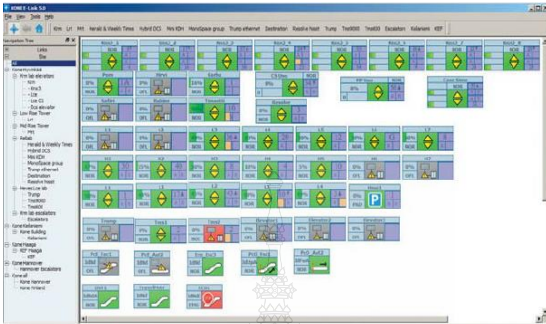
รูปที่ 3.3 หน้าจอแสดงผลของระบบควบคุมและสังเกตการณ์ของระบบลิฟต์
