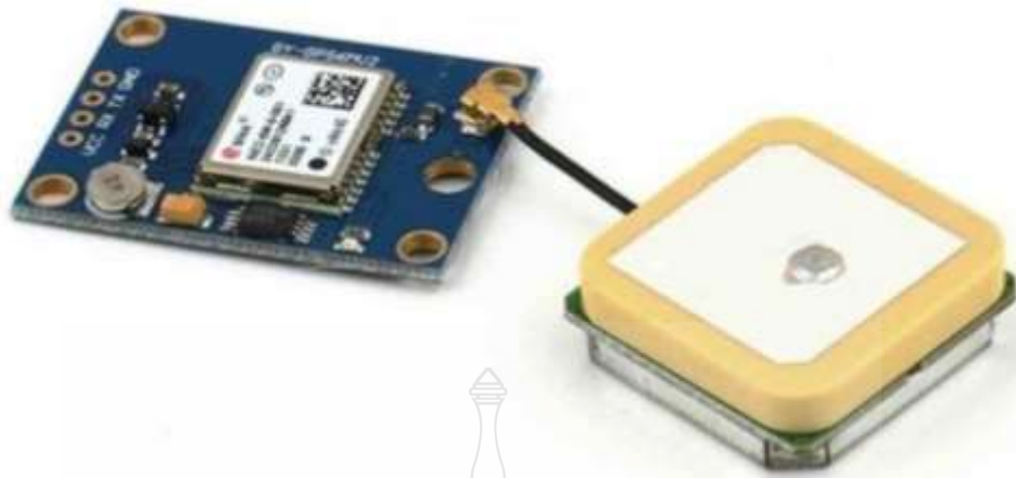
Figure 2.11 Ublox NEO-7M GPS Module [51]
