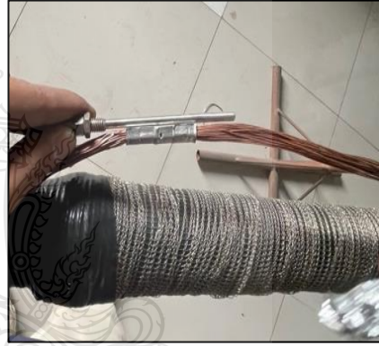
รูปที่ 3.6 แบบจำลองภาพตัดจุดต่อสายเคเบิลใต้ดิน XLPE 12/20 24(kV) ขนาด 400 mm 2 แบบต่อกราวนด์ 1 จุด ขั้วต่อกราวนด์เหลี่ยม
