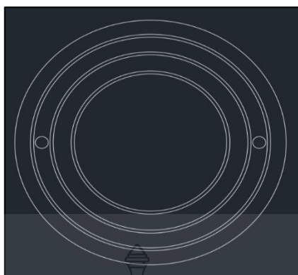
รูปที่ 3.11 แบบจำลองภาพตัดจุดต่อสายเคเบิลใต้ดิน XLPE 12/20 24(kV) ขนาด 400 \text{ mm}^2 แบบต่อกราวนด์กลม 2 จุด ที่ความหนา XLPE 2.75 \text{ mm}^2
