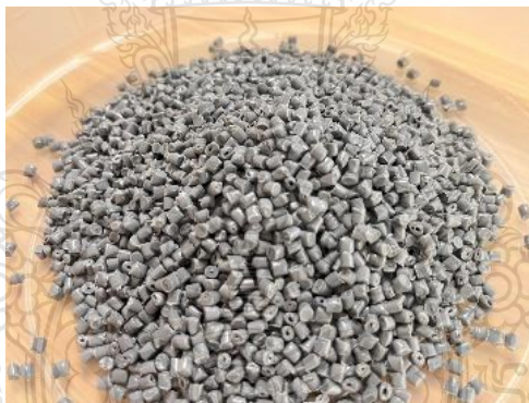
รูปที่ 3.8 เม็ดพลาสติกพอลิเอทิลีนความหนาแน่นสูงที่ผ่านการรีไซเคิลแล้ว
