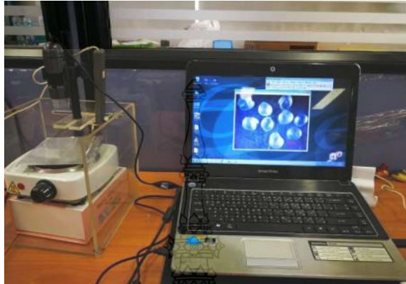
รูปที่ 3.17 เตาให้ความร้อน (Hot Plate)
