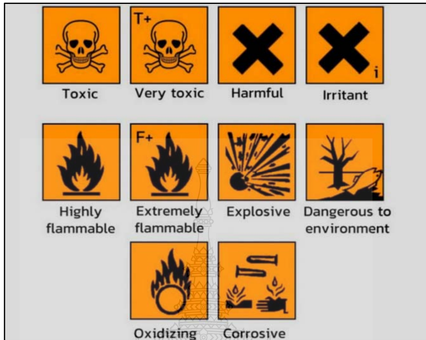
ภาพที่ 3.40 สัญลักษณ์เตือนสารเคมีอันตรายของระบบ ECC
