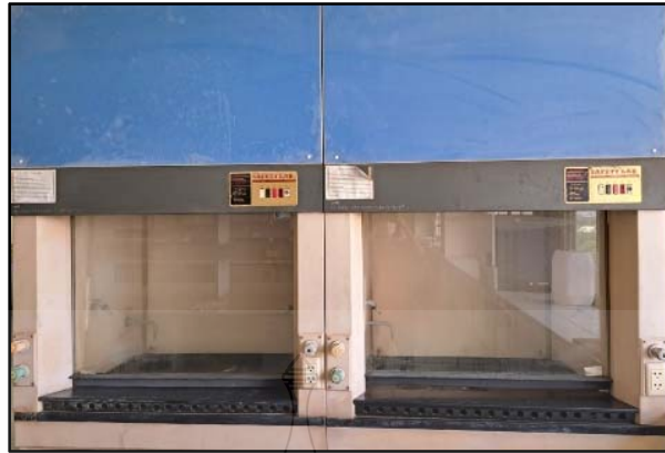
ภาพที่ 3.2 ตู้ดูดควัน (Hood)
