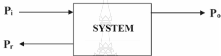
รูปที่ 2.22 การเกิดการย้อนกลับของกำลังงาน [15]
