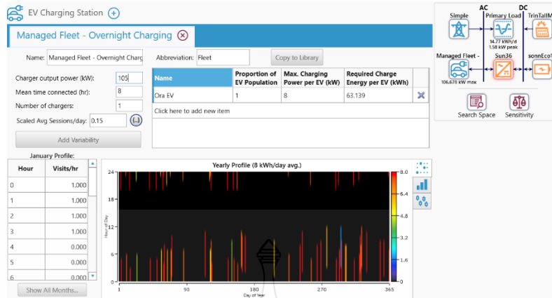
รูปที่ 3.21 โปรแกรมจำลองการอัดประจุยานยนต์ไฟฟ้าแบบปกติยี่ห้อที่ 1 ที่มีกำลังเครื่องยนต์ขนาด 105 kW จำนวน 1 คัน
