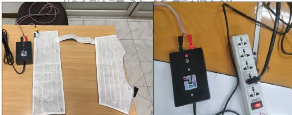
รูปที่ 4.7 รูปแบบการต่อชุดวงจรไฟแผงทำความร้อนใส่ RCD กันไฟรั่ว
