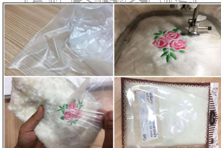
รูปที่ 2.46 แผ่นรองปักแบบฟิล์มละลายน้ำ [22]
