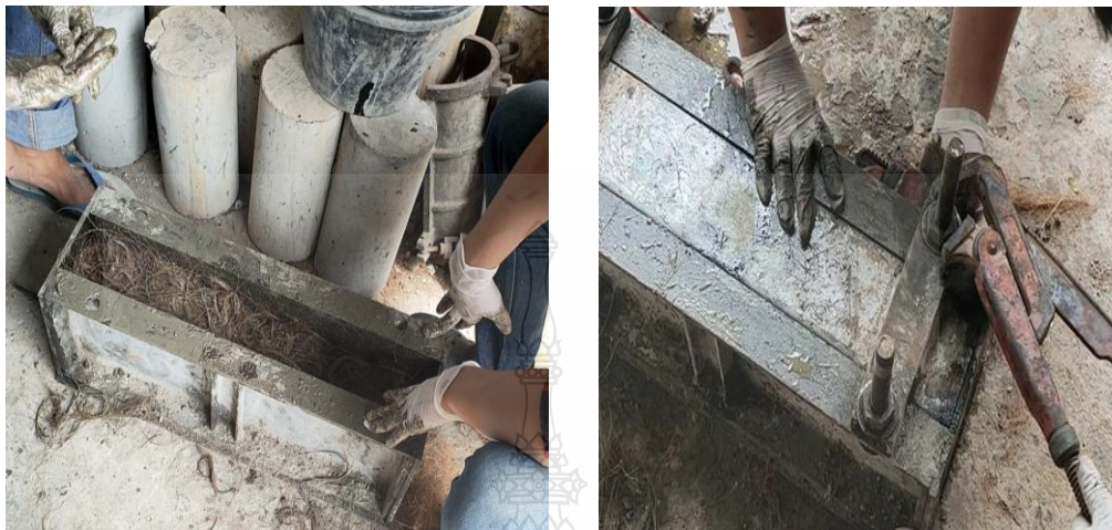
รูปที่ 3.6 นำวัสดุที่ผสมเสร็จแล้วมาใส่ในแบบแล้วอัดขึ้นรูป
