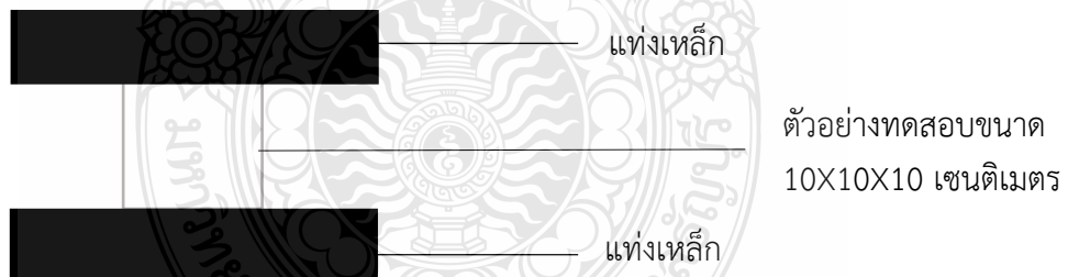
รูปที่ 2.1 การทดสอบแรงอัด (Compressive Strength)
