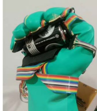
(A) การจับวัตถุแบบกำเต็มมือเพื่อสำรวจวัตถุของมนุษย์ (B) การจับวัตถุแบบกำเต็มมือเพื่อสำรวจวัตถุโดย Glove Tactile Sensor
