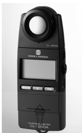
ภาพที่ 3.1 Konica Minolta Chroma Meter CL-200A
