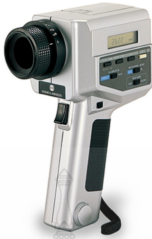
ภาพที่ 2.8 Konica Minolta Chroma Meter CS-100A
