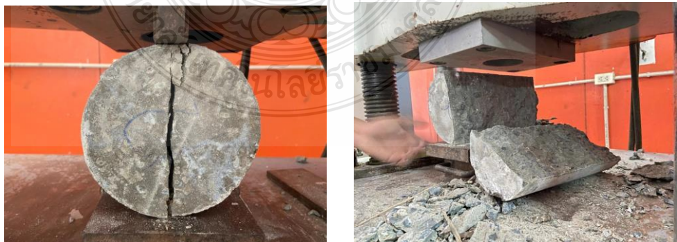
รูปที่ 3.10 การทดสอบกำลังดึงโดยวิธีผ่าซีกของคอนกรีต (splitting tensile strength)
