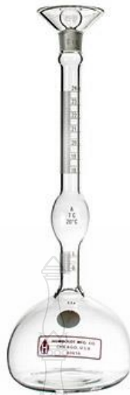
รูปที่ 3.1 ขวดเลอชาเตอลิเอร์ (la chatelier flask)
