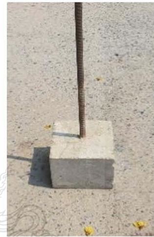
รูปที่ 3 ทรงลูกบาศก์ขนาด 15 x 15 x 15 เซนติเมตร
