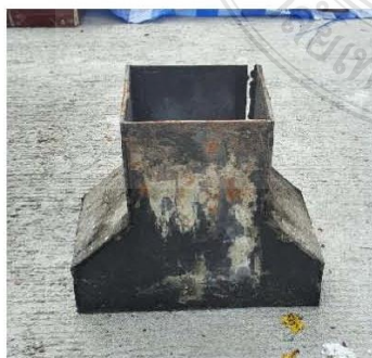
รูปที่ 6 แบบรูปตัวไอ ขนาด 20 x 10 x 30 เซนติเมตร
