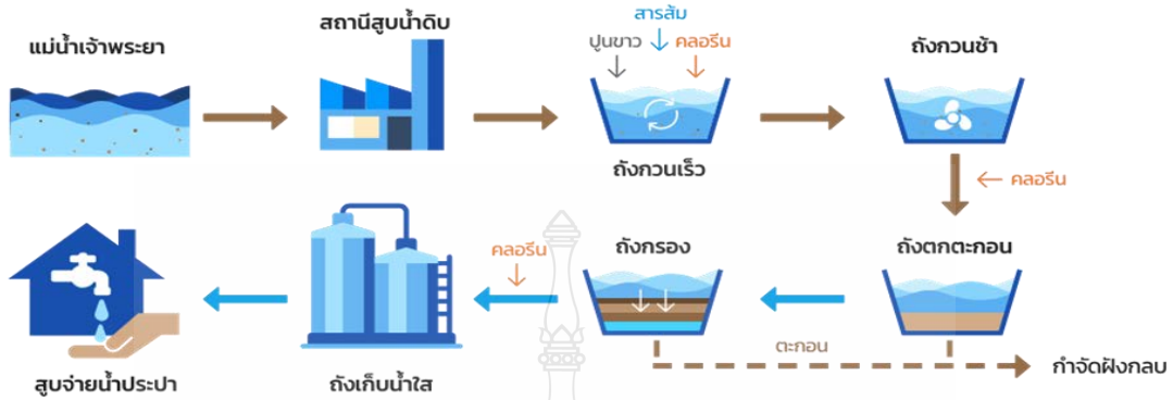
รูปที่ 2.1 กระบวนการผลิตน้ำประปาของการประปานครหลวง
