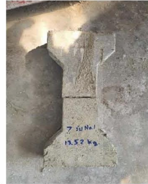
รูปที่ 7 ตัวอย่างรูปตัวไอขนาด 10 x 20 x 60 เซนติเมตร
