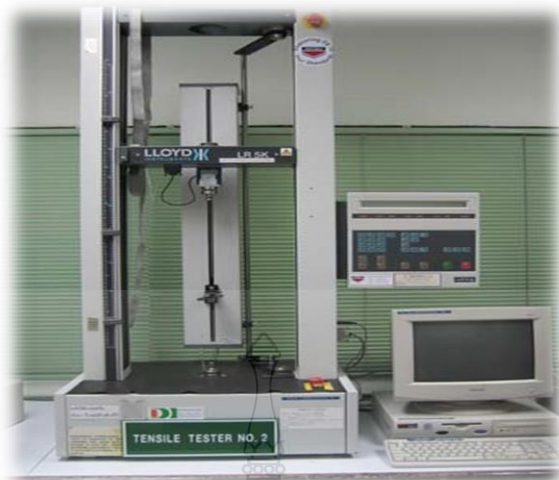
รูปที่ 2.8 เครื่องทดสอบแรงดึง (Universal Testing Machine)
