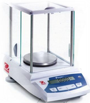
รูปที่ 3.4 เครื่องชั่งน้ำหนักที่มีความละเอียดทศนิยม 3 ตำแหน่ง
