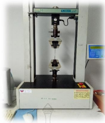
รูปที่ 3.12 เครื่อง Universal testing machine สำหรับการทดสอบแรงดึง
