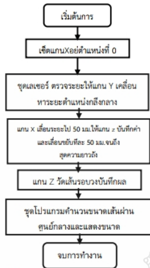
รูปที่ 5 ขั้นตอนการโปรแกรมสั่งการทำงานหุ่นยนต์หาขนาดเส้นผ่านศูนย์กลาง
