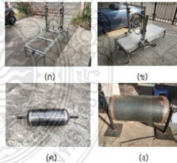
รูปที่ 8 การสร้างประกอบหุ่นยนต์คาร์ทีเซียน และถึงความดันขนาด 20 ลิตร
