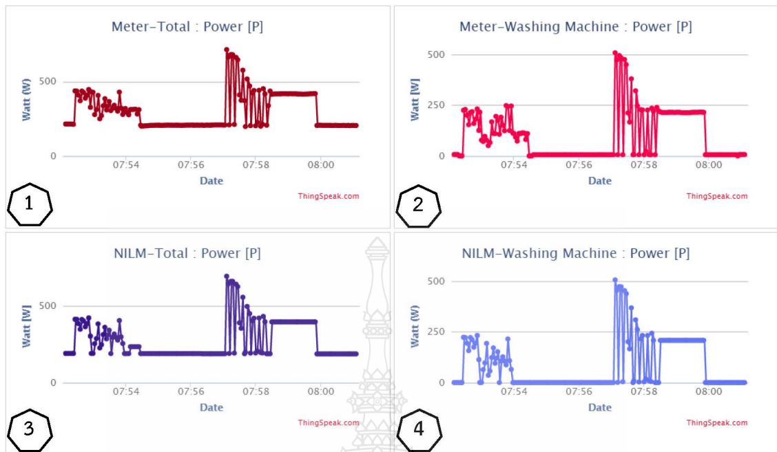
รูปที่ 3.56 การแยกกำลังไฟฟ้าของเครื่องซักผ้าและส่งข้อมูลแสดงแบบเวลาจริง
