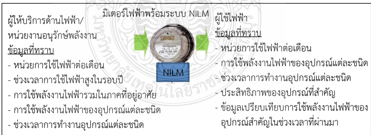
รูปที่ 1.2 การตรวจวัดพลังงานไฟฟ้าพร้อมระบบ NILM
