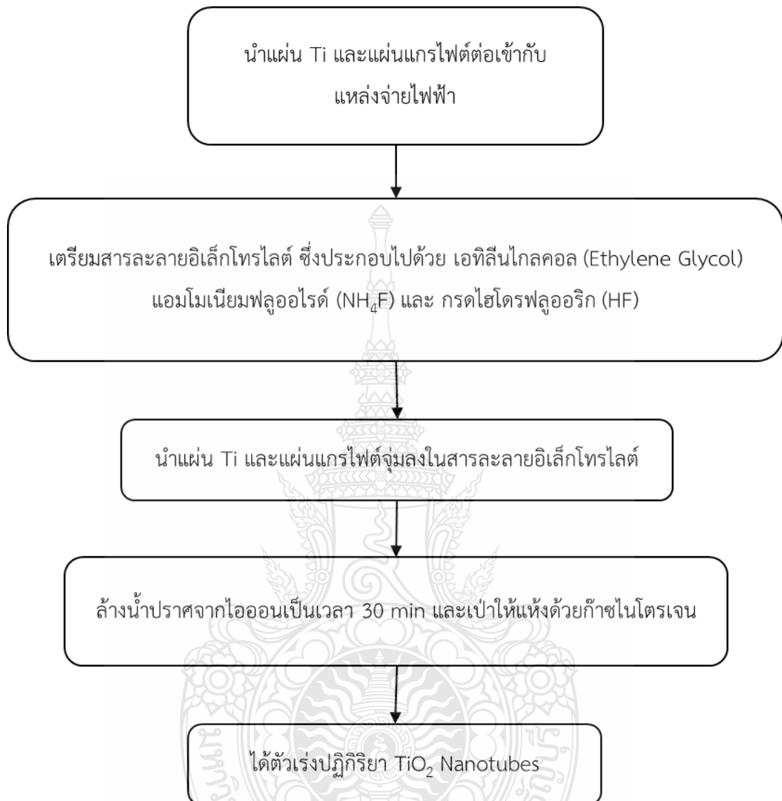
รูปที่ 3.4 วิธีการเตรียมตัวเร่งปฏิกิริยา TNTs ด้วยกระบวนการแอนโนไดเซชัน
