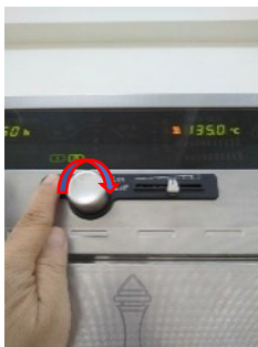
ภาพที่ 3.30 แสดงการหมุนปุ่ม power ตู้อบลมร้อนเพื่อเพิ่มอุณหภูมิ
