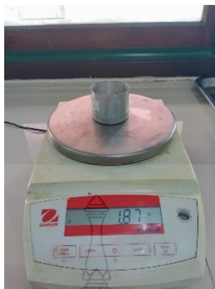
ภาพที่ 3.59 แสดงการอ่านน้ำหนักจากเครื่องชั่ง 2 ตำแหน่ง
