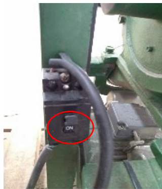
ภาพที่ 3.44 แสดงตำแหน่ง on ของสวิตช์เครื่องบดธัญพืช
