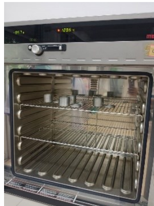
ภาพที่ 4.41 แสดงการการศึบถ้วยตัวอย่างไปอบในตู้อบลมร้อน
