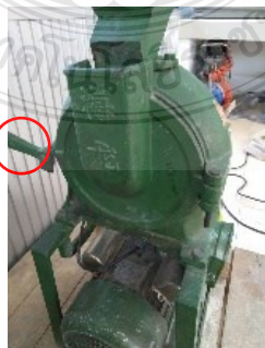
ภาพที่ 3.40 แสดงการสลักยึดเข้าตะแกรงตำแหน่งปลดล็อกเครื่องบดธัญพืช
