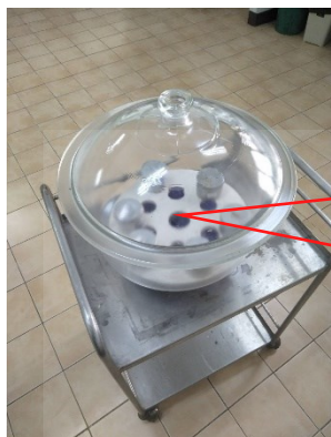
ภาพที่ 4.36 แสดงการวางถ้วยอลูมิเนียมในโถดูดความชื้น
