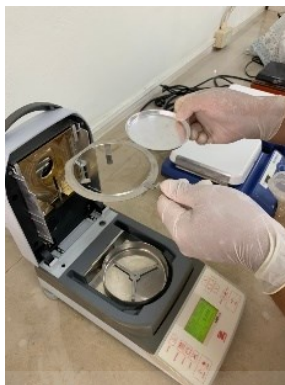
ข. การใส่ถาดเข้าไปในที่รองถาดเครื่องวิเคราะห์ความชื้น 1
