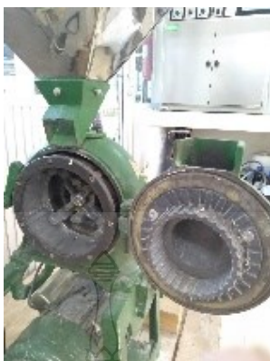
ภาพที่ 3.41 แสดงการใส่ตะแกรงบดในเข้าตะแกรงเครื่องบดธัญพืช
