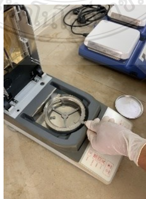
ก. การจับด้ามที่รองถาดเครื่องวิเคราะห์ความชื้นขึ้น
