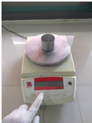
ภาพที่ 3.61 แสดงการกดปุ่ม Tare บนเครื่องชั่ง 2 ตำแหน่ง เพื่อหักน้ำหนักภาชนะ
