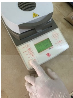
ภาพที่ 3.75 แสดงการกดปุ่ม Start เพื่อให้เครื่องวิเคราะห์ความชื้นเริ่มทำงาน
