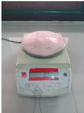
ภาพที่ 3.55 แสดงตัวอย่างเครื่องชั่ง 2 ตำแหน่ง
