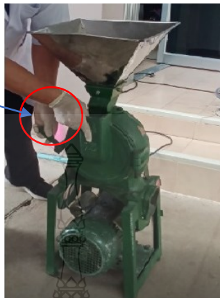
ภาพที่ 4.6 แสดงการเปิดฝาเข้าตะแกรงบดเครื่องบดธัญพืช
