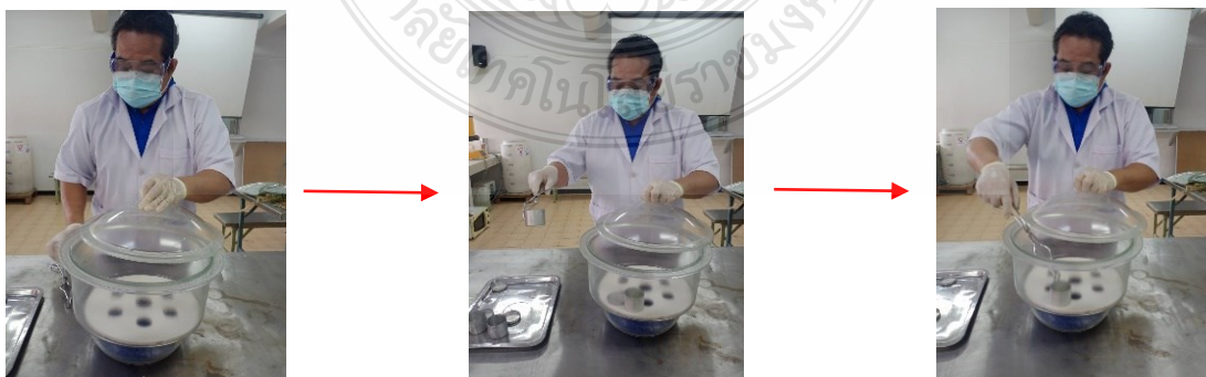
ภาพที่ 3.21 แสดงการนำถ้วยอย่างเข้าวางในโถดูดความชื้น
