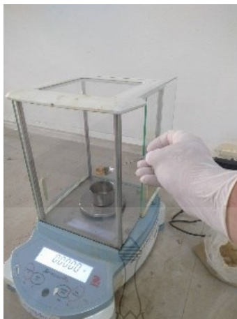
ภาพที่ 3.53 แสดงการตักตัวอย่างใส่ในภาชนะในเครื่องชั่ง 4 ตำแหน่ง
