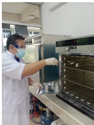
ภาพที่ 4.41 แสดงการการศึบถ้วยตัวอย่างไปอบในตู้อบลมร้อน
