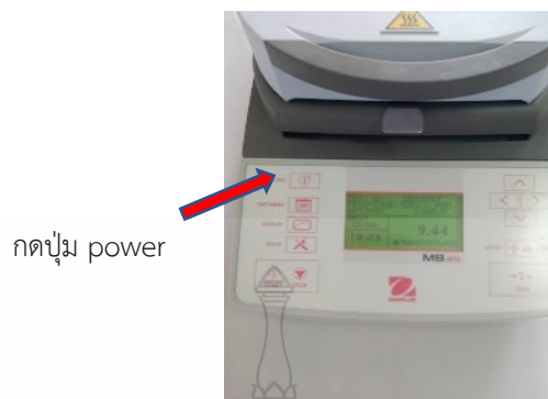
ภาพที่ 3.68 แสดงการเปิดเครื่องวิเคราะห์ความชื้น
