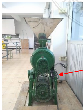
ภาพที่ 4.11 แสดงตำแหน่งสวิตซ์เครื่องบดธัญพืช
