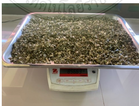
ภาพที่ 4.52 แสดงการชั่งตัวอย่างที่อบแล้วด้วยเครื่องชั่ง 2 ตำแหน่ง
