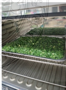
ภาพที่ 3.9 แสดงการนำหญ้าเนเปียร์เข้าอบในตู้อบลมร้อน
