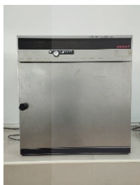
ก.Treatment 1 Hot Air Oven ที่อุณหภูมิ 135 °C ใช้เวลา 2 ชั่วโมง
