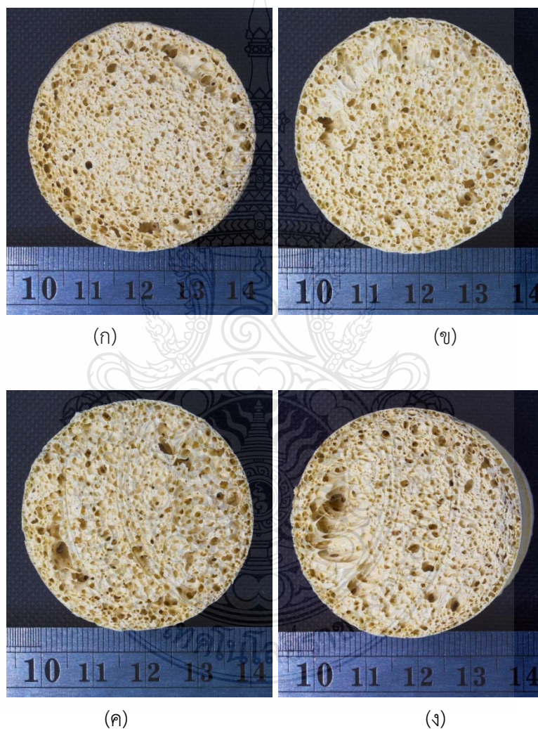
รูปที่ 4.32 ภาพถ่ายแสดงโพลีเมอย่างขึ้นรูปแบบการพาความร้อน ไม่ควบคุมการขยายตัว สัดส่วนสารเกิดฟองโซเดียมไฮโดรเจนคาร์บอเนต 10 ส่วนในร้อยละ (ก) สัดส่วนสารกระตุ้นซิงค์ออกไซด์ 1 ส่วนในร้อยละ (ข) สัดส่วนสารกระตุ้นซิงค์ออกไซด์ 2 ส่วนในร้อยละ (ค) สัดส่วนสารกระตุ้นซิงค์ออกไซด์ 3 ส่วนในร้อยละ (ง) สัดส่วนสารกระตุ้นซิงค์ออกไซด์ 4 ส่วนในร้อยละ
