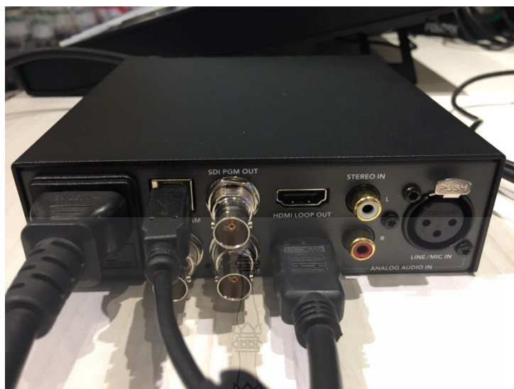
ภาพที่ 4-20 การเชื่อมต่อระบบภาพและเสียง Blackmagic Web Presenter
