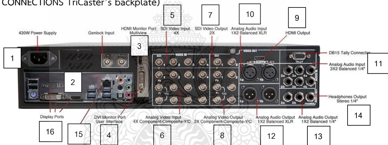
ภาพที่ 4-3 การติดตั้งและเชื่อมต่อระบบสัญญาณภาพและเสียงของเครื่อง Tri Caster 410
