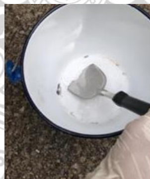
ภาพที่ 44 แสดงตัวอย่างน้ำประสานทองหลังสะดุ
