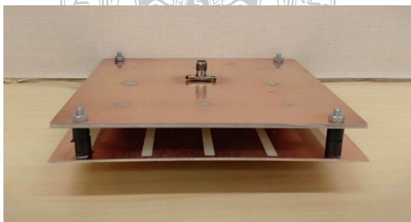
รูปที่ 4.25 โครงสร้างสายอากาศโมโครสตริป EBG ต่อร่วมกับแผ่น PRS
