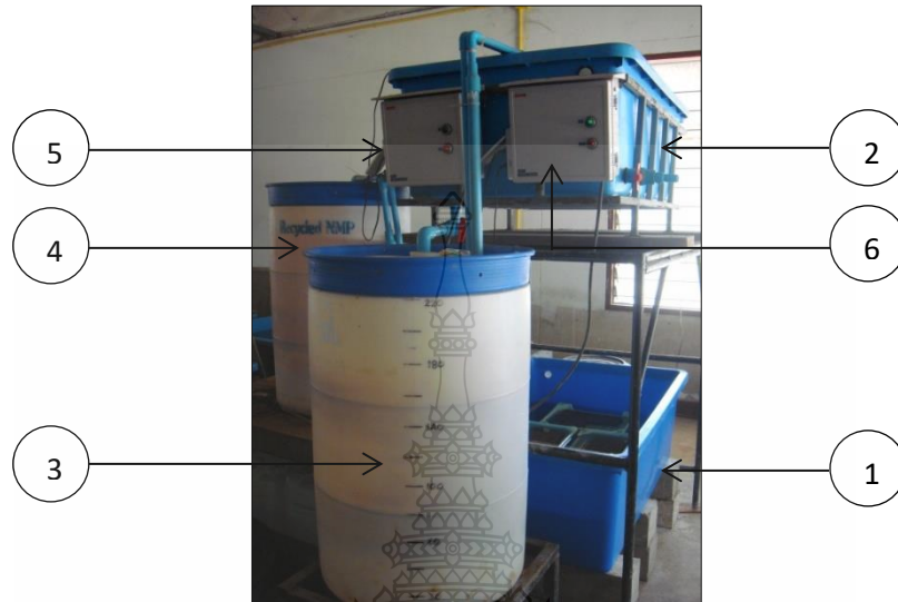
รูปที่ 3.4 ส่วนประกอบของระบบการหมุนเวียนสารละลาย ในสภาวะเปียกสลับแห้ง
