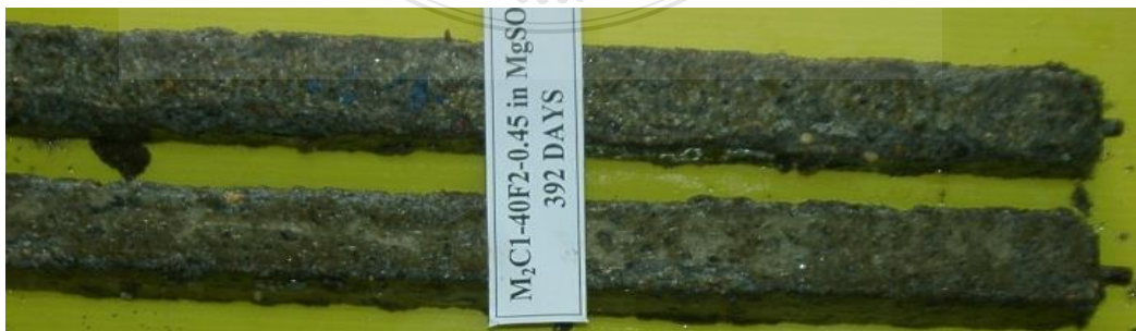
รูปที่ 4.2 ภาพถ่ายของมอร์ตาร์ในสารละลายแมกนีเซียมซัลเฟตที่อายุ 392 วัน
