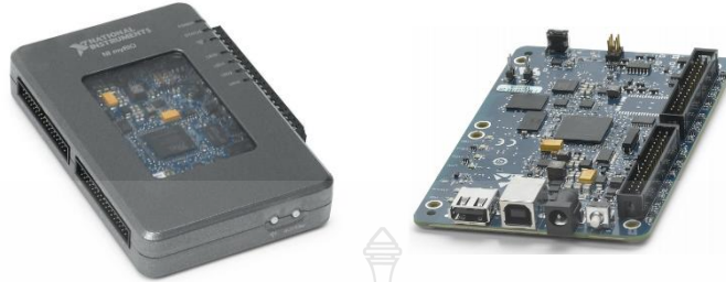
รูปที่ 2.12 ไมโครคอนโทรลเลอร์ NI myRIO [11]
