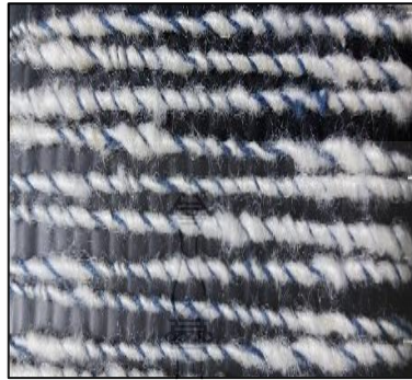
รูปที่ 4.3 ลักษณะเส้นด้ายพิเศษชนิดเส้นด้ายรวมแบบเส้นด้ายเกลียว
