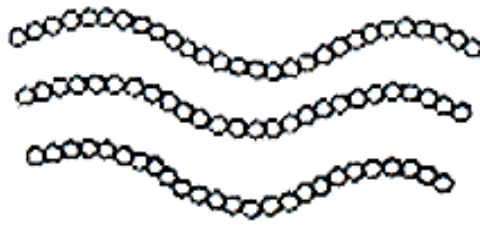
รูปที่ 2.1 โครงสร้างพอลิเมอร์แบบเส้น [14]
