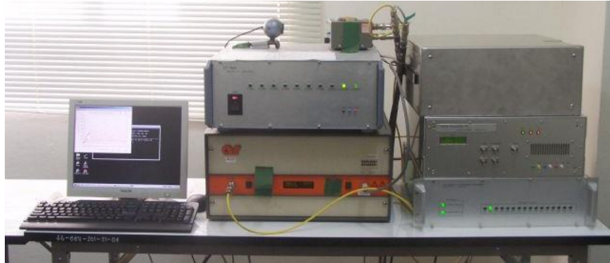
รูปที่ 3.4 คอมพิวเตอร์ที่ใช้ในการเก็บข้อมูลภาพไอโอโนแกรม [28]
