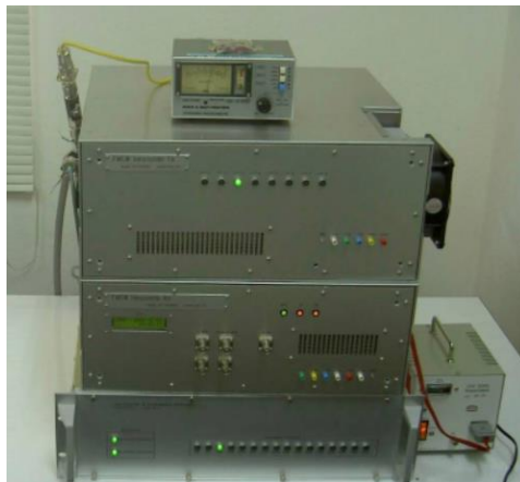
รูปที่ 3.1 เครื่องส่งและเครื่องรับเป็นรุ่น SKI-96092 FM/CW Radar [12]
