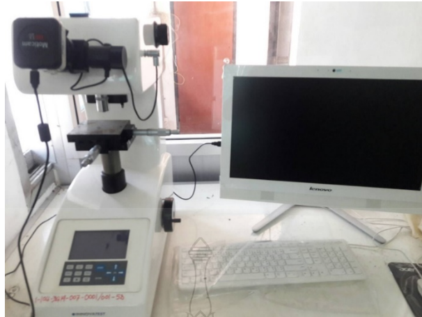
รูปที่ 3.7 เครื่อง Automatic Turret Digital Display Micro Vickers Hardness Tester
