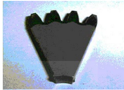
รูปที่ 2.28 แสดงชั้นความแข็งลึกของการชุบผิวแข็งแบบคาร์บูไรซิ่งหรือคาร์โบไนไตรดิง และแบบอินดักชั่นพบว่า การชุบแข็งแบบอินดักชั่น ความร้อนจะซึมเข้าไปลึกกว่าโดยเห็นได้อย่างชัดเจน [25]
