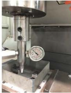
รูปที่ 1 แสดงกระบวนการกรัดผิวแข็งด้วยบอล[5]
