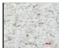
(ข) เส้นด้ายพอลิแลคติกแอกซิดผสมเส้นใยทะเลลายปาล์มน้ำมันร้อยละ 0.5
