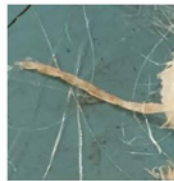
(ง) เส้นด้ายพอลิแลคติกแอกซิดผสมเส้นใยทะเลลายปาล์มน้ำมันร้อยละ 2 (จ) รูหน้าแปลน (Die) ดายแบบชลิท
