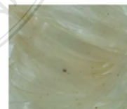
(ข) เส้นด้ายพอลิแลคติกแอซิดผสมเส้นใยทะเลลายปาล์มน้ำมันร้อยละ 0.5
