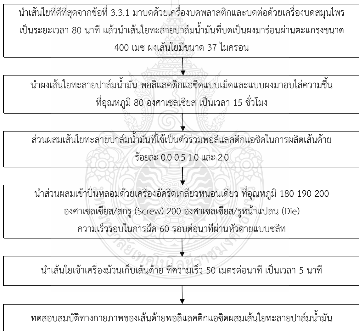
รูปที่ 3.8 ขั้นตอนการขึ้นรูปเส้นด้ายพอลิแลคติกแอซิดผสมเส้นใยทะเลลายปาล์มน้ำมัน
